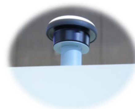
車体上部のGNSS(全地球航法衛星システム)。精度を高めるために左右計2個取付
