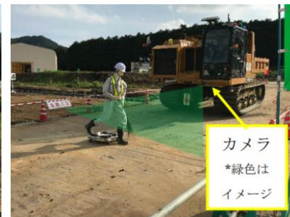
人体検知システム試験状況（人形を使用して実施）
