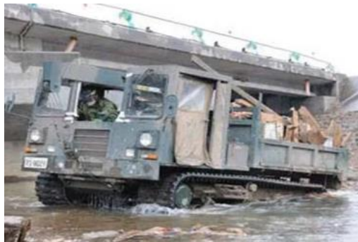
水辺を乗り越え廃材を運ぶ 資材運搬車(陸上自衛隊仕様)
