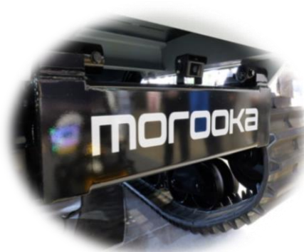
MAVE001の車体後方下部。リアバンパーの上部には後方確認用のカメラを搭載
