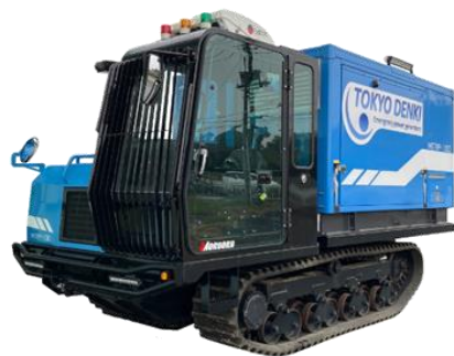
ゴムクローラ式移動電源車
