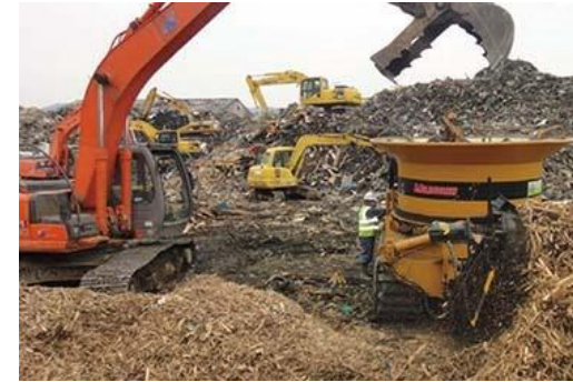
油圧ショベルと協働し木材がれ きを粉砕する自走式木材破砕機
