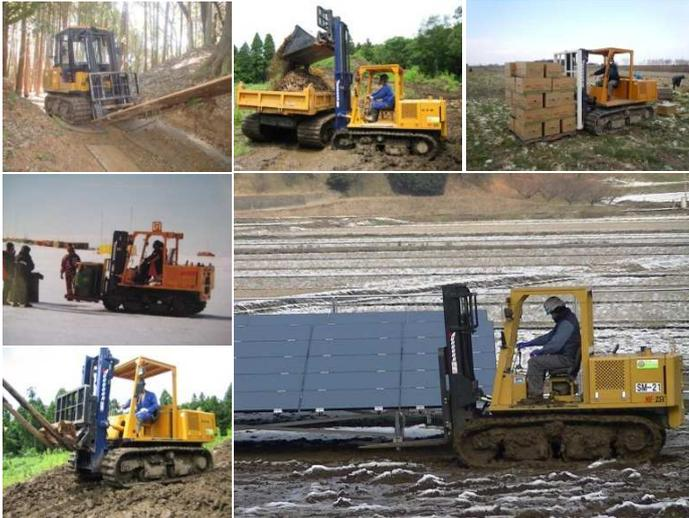
ゴムクローラのパイオニアである諸岡が不整地運搬車輛で培った足回りの技術を応用してできたのが不整地専用のクローラフォークリフト MF-25V です。MF-25V であれば畑などの農地はもちろん起伏が激しく路面の荒れた林道や降雨や降雪により泥濘化した路面でも走行・運搬が可能です。また南極昭和基地でも採用されており、長年にわたり南極の凍った大地で活躍しています。また近年では不整地の多いメガソーラー建設の現場でも多く採用されています。
