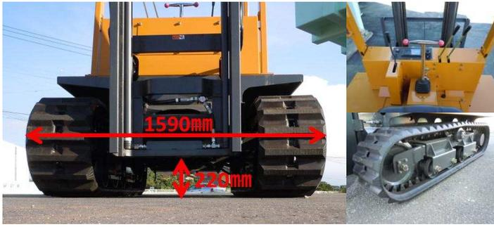
クローラフォークリフト MF-25V は様々な現場にマッチする使いやすい最適な車幅と最低地上高、泥地などの不整地での走行を可能にする強靱な足回り、操作性に優れたT字一本レバーなど不整地での使用を目的として作られた世界で唯一のゴムクローラ式フォークリフトです。
