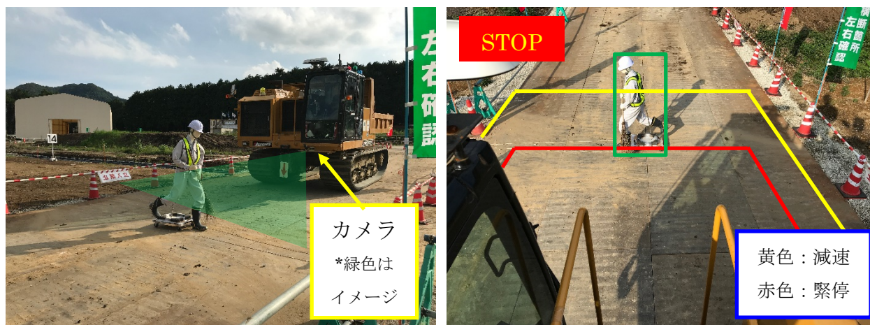
写真2 人体検知システム試験状況（人形を使用して実施）
