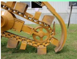
バケット方式による 連続掘削
