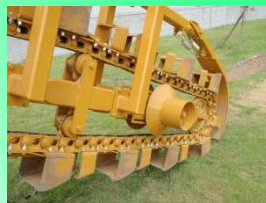
掘削土の落下を防ぐ締 固め用サイドローラ
